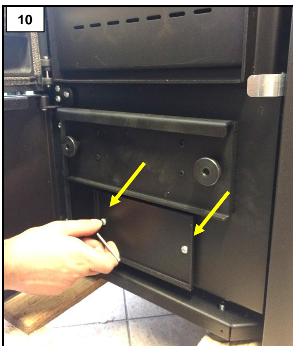
Das Inspektionsblech durch Lösen der beiden Schrauben entfernen (Abb. 10) und die Rückstände im Innern des inspektionierten Raums absaugen (Abb. 11).
