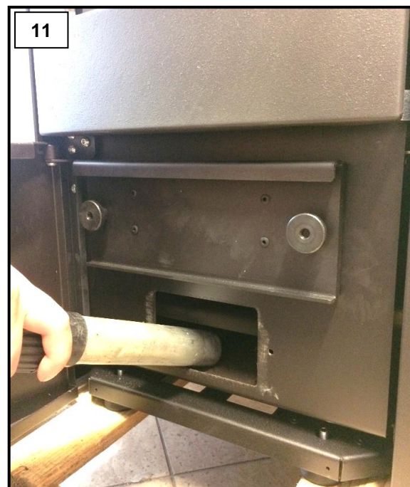
Das Inspektionsblech durch Lösen der beiden Schrauben entfernen (Abb. 10) und die Rückstände im Innern des inspektionierten Raums absaugen (Abb. 11).
