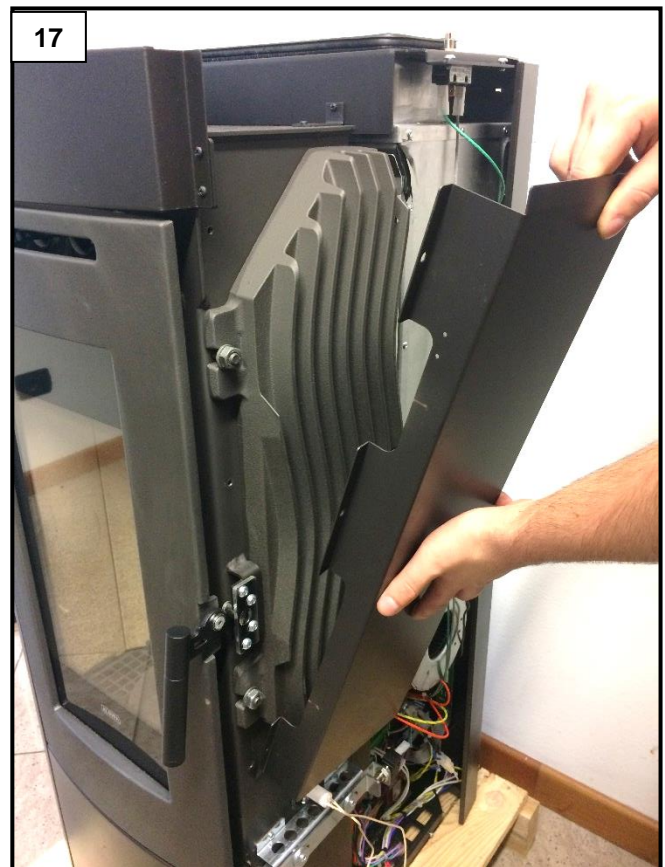
Abdeckung des Gusseisen-Wärmetauschers abnehmen (Abb. 17), dazu die fünf auf dem Foto gezeigten Schrauben herausdrehen (Abb. 16).
