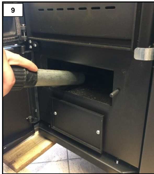
Eventuelle Rückstände im Aschenkasten absaugen (Abb. 9).
